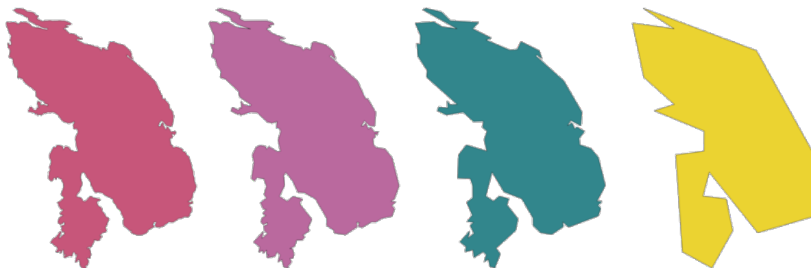
Fig. 9.28: Från vänster till höger, källager och ökande förenklingstoleranser
