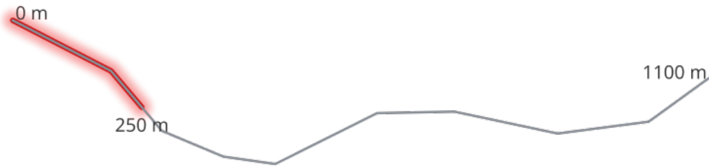
Fig. 24.89: Substringslinje med startavståndet inställt på 0 meter och slutavståndet på 250 meter.
