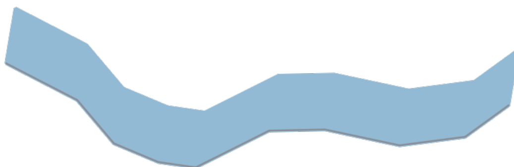
Fig. 9.18: Generera en polygon genom att extrudera en linje med förskjutning i x- och y-riktningarna
