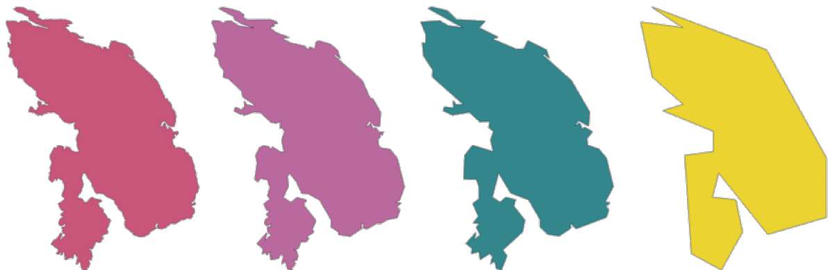
Fig. 24.105: Från vänster till höger, källager och ökande förenklingstoleranser
