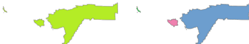
Fig. 24.93: Till vänster källagret med flera delar och till höger utmatningsresultatet med en enda del
