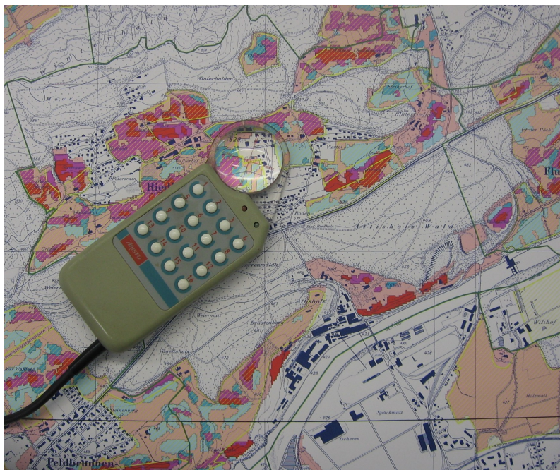
Fig. 5.8: Ett digitaliseringsbord och en puck används av GIS-proffs när de vill digitalisera objekt från befintliga kartor.
