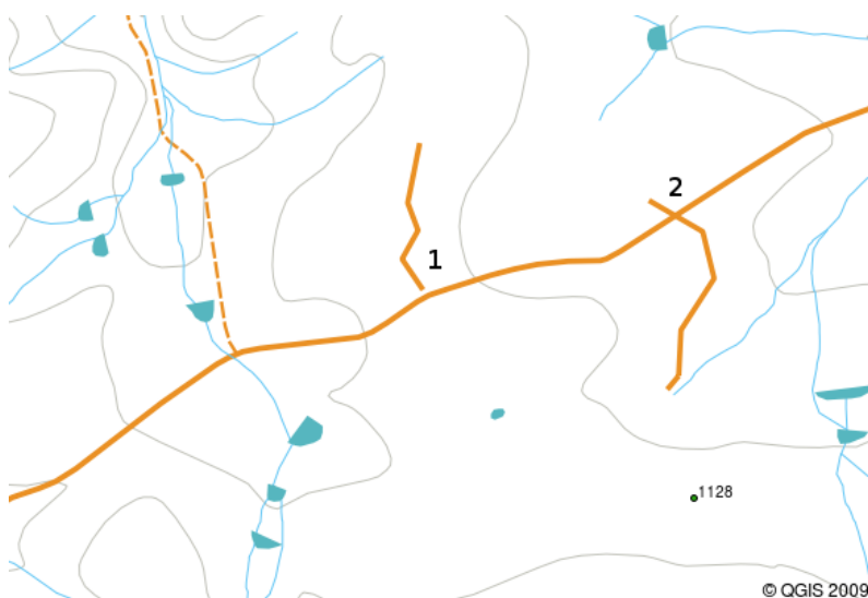
Fig. 3.13: Undershoots (1) uppstår när digitaliserade vektorlinjer som ska ansluta till varandra inte riktigt rör vid varandra. Overshoots (2) inträffar om en linje slutar bortom den linje som den ska ansluta till.
