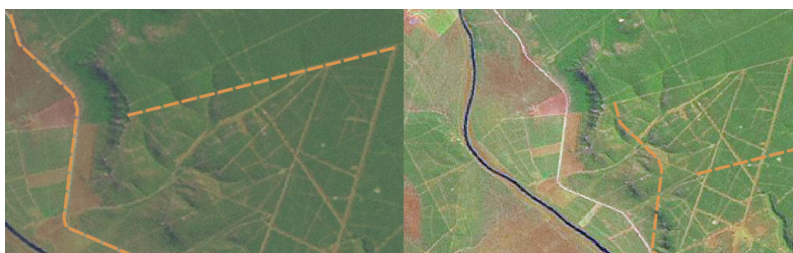
Fig. 5.9: Vikten av att använda korrekt georefererade rasterbilder för digitalisering med huvudet före. Till vänster ser vi att bilden är korrekt georegistrerad och att vägobjekten (i orange) överlappar varandra perfekt. Om bilden är dåligt georefererad (som visas till höger) kommer objekten inte att vara väl inriktade. Ännu värre är att om bilden till höger används som referens när nya funktioner ska registreras kommer de nyregistrerade uppgifterna att vara felaktiga!
