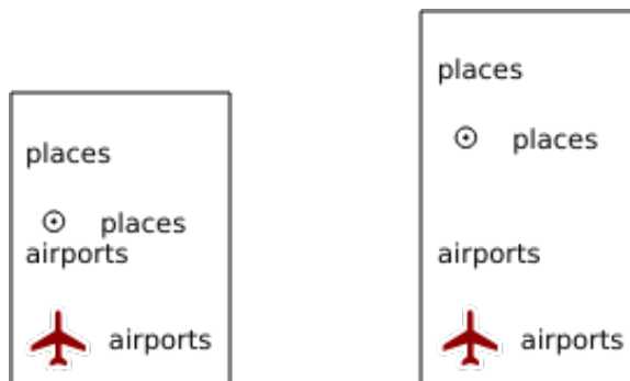
Fig. 3.7: Till vänster LAYERSPACE=0 och till höger LAYERSPACE=10
